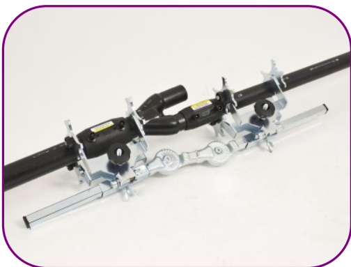
Schweißgerät GET control mit Haltevorrichtung auch für Rohrzusammenführungen
